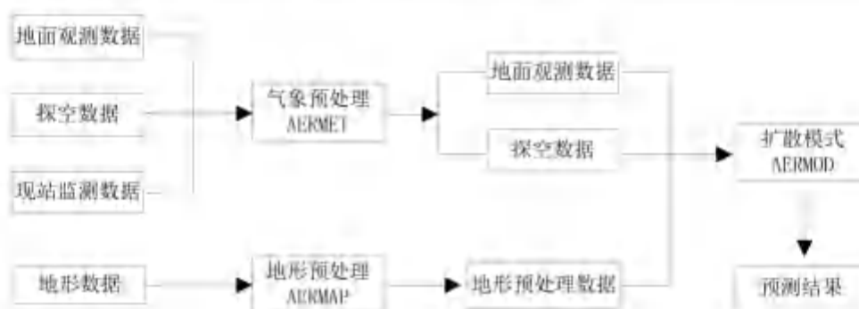
图 6.1.3-i AERMOD 模式系统流程
